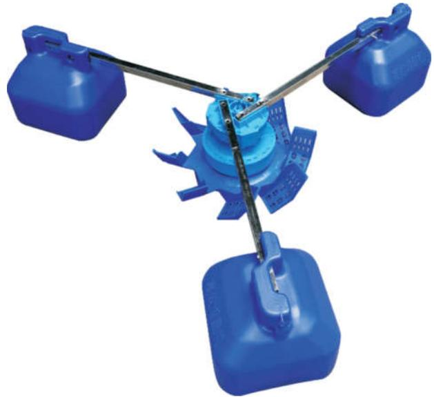
养殖户亲测：1.5kw变频增氧机的增氧能力几乎超过传统3kw叶轮增氧机，按照测试得到电压和电流，变频是1580瓦，旧式增氧机3028瓦，耗电量相差一倍
