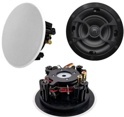
LB-511S是一款高音质吸顶扬声器。表面采用美观的黑色涂层和白色网罩，时尚精巧的外型可与现代化的室内装潢完美融合，相得益彰。低音采用聚丙烯振膜加橡胶折环，以表现平滑出色的低频响应和甜润温暖的中频；高音采用天然蚕丝球顶音膜，磁液冷却，钕铁硼磁钢，让声音清晰明亮，委婉动听；高音可因场地环境倾斜30度，360度内自由转动，并PTC过载保护；-12dB/Oct低通滤波器，-18dB/Oct高通滤波器，让每个扬声器工作在较佳的频带内。简单方便的功率设置，操作容易。适合于多种场合，特别在商店、百货公司、学校、办公室、酒店和餐馆内的内嵌式音响应用场合，可以发挥卓越的语音及音乐播放功能。
