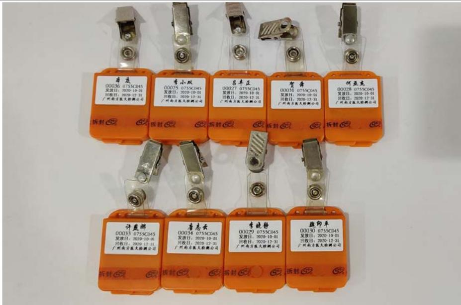
图 5-2 个人剂量计实物图
