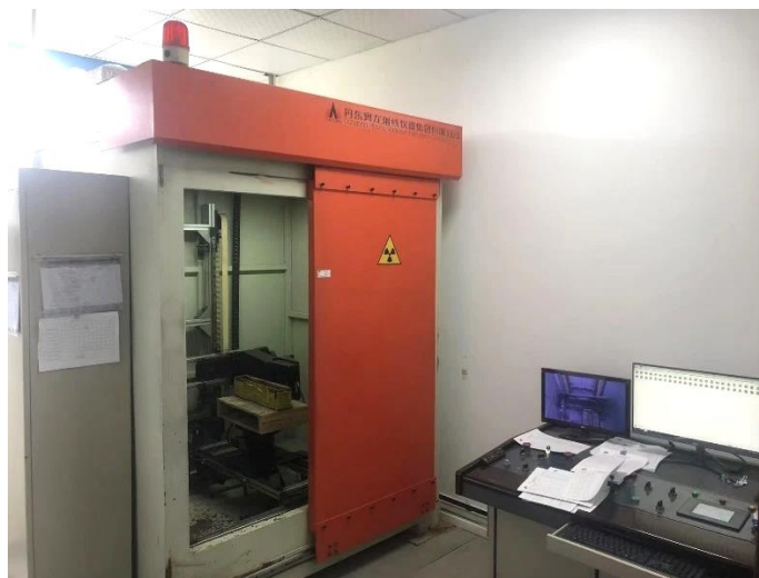
图 9-2 本项目 X 射线实时成像检测系统外观图
