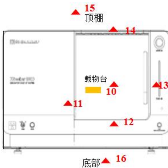
图 6-1 X 射线检测系统周围检测点位示意图 (1)
