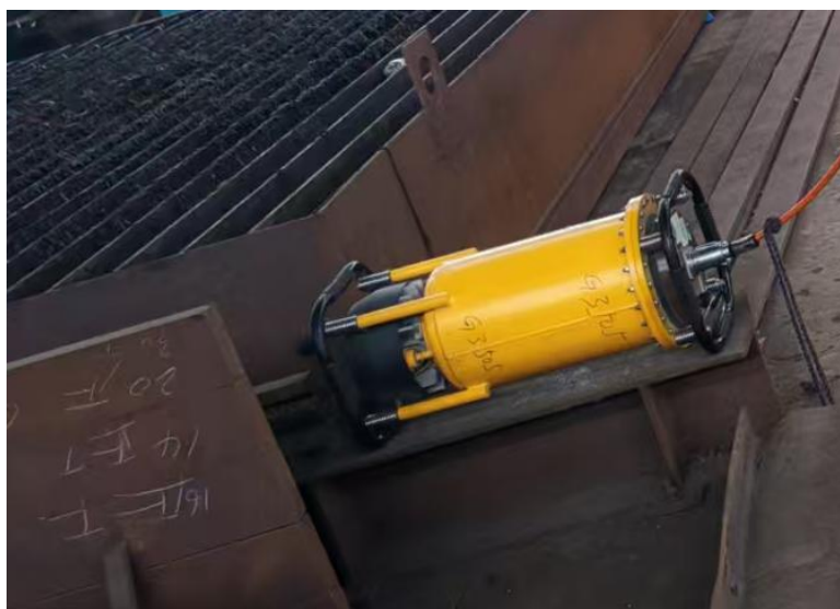
图 2-5 X 射线探伤机外观示意图
