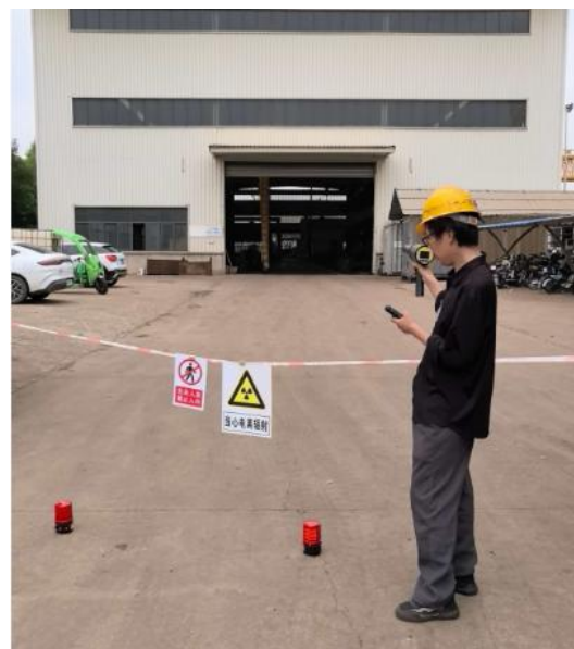
图 10 辐射工作人员携带个人剂量报警仪、便携式 X-γ 剂量率仪
