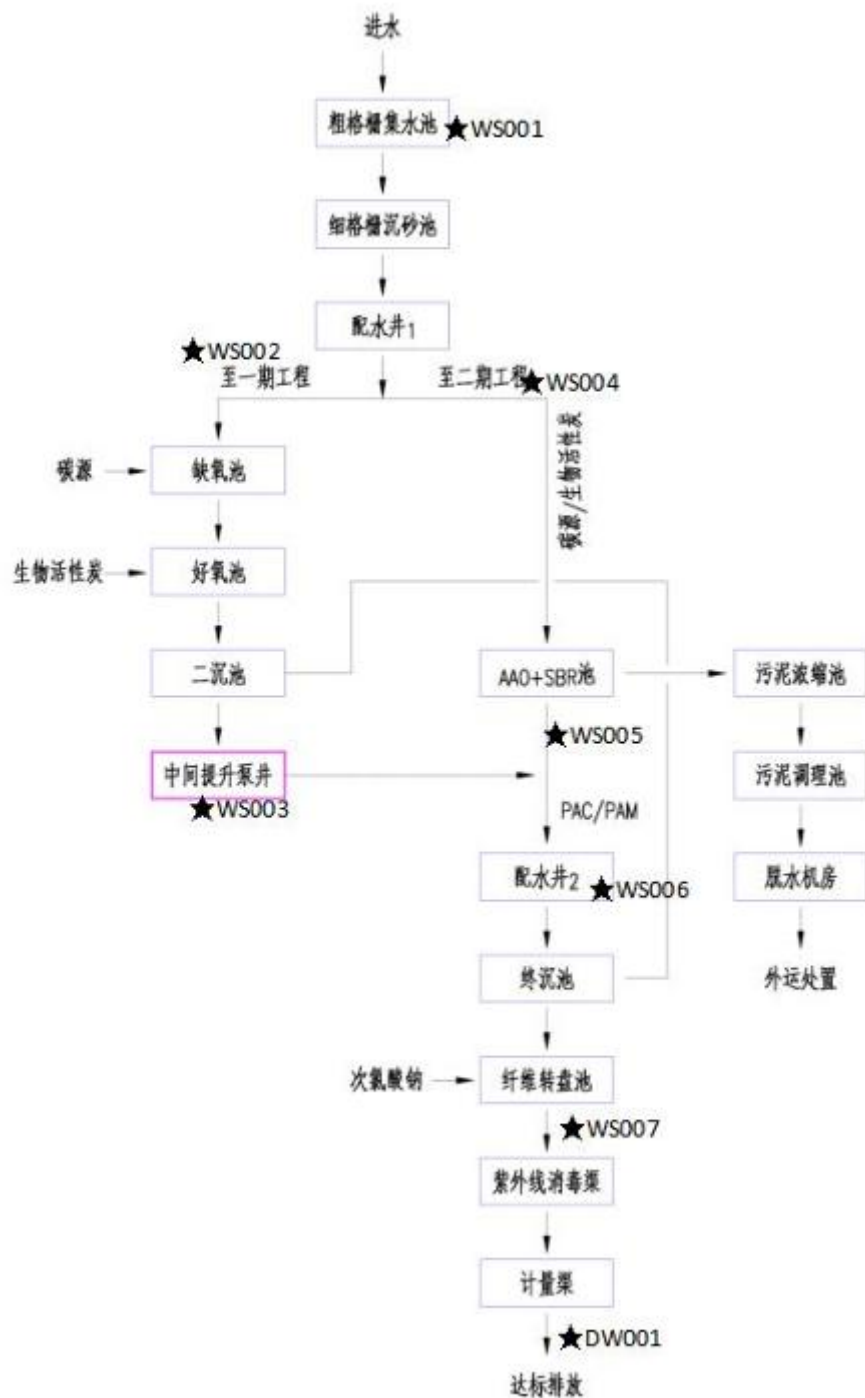
图 4-2 云和座城市污水处理厂废水处理工艺流程图
